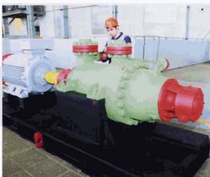
Высоконапорный насос ТСД 210/800
