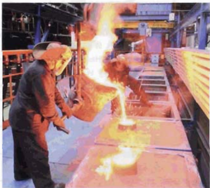
Новая линия литья по выплавляемым моделям
