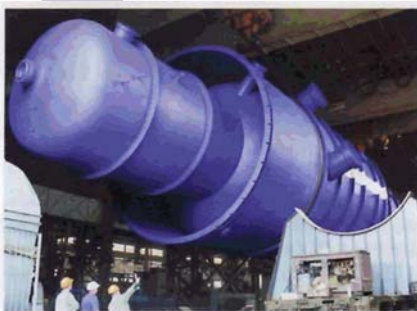
Вакуумная колонна диаметром 8,5 м, массой 366 т
