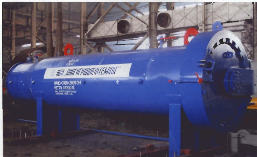
Устройство камер запуска (приема) средств очистки и диагностики с затвором байонетного типа
