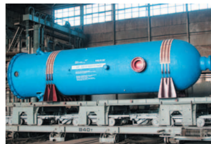
Реактор для Мозырского НПЗ на транспортёре
