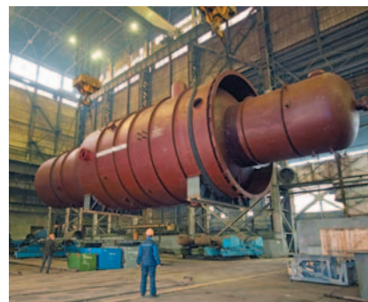
Подготовка колонны к транспортировке
