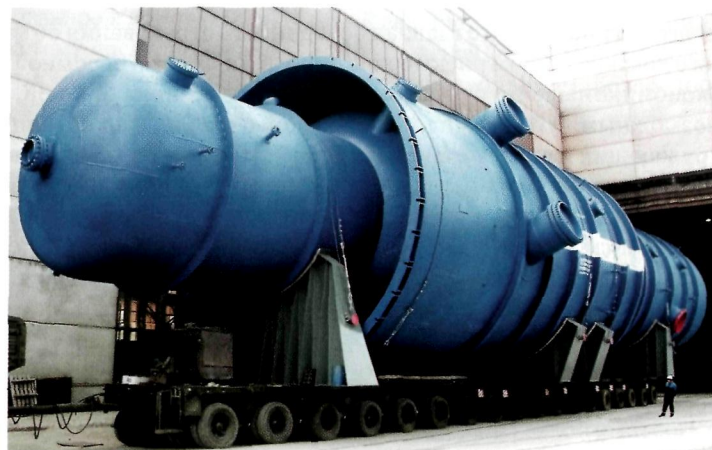
Вакуумная колонна диаметром 8,5 метров и весом 336 тонн отправилась на крупнейший в России комплекс нефтеперерабатывающих заводов, строящийся в Нижнекамске.
